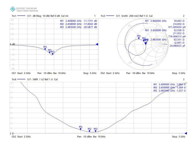
Figure 8 Antenna S parameters
