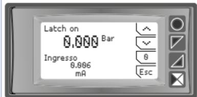
Per utilizzare la funzione LATCH ON, entrare in configurazione, impostare **Acquisizione** nel par. 8 **Latch on** e premere Sel: appare la schermata a lato.
