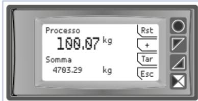
Premendo "Funzione somma" si entra nella pagina dedicata. Premendo "+" si somma il valore **Processo** al contatore. È possibile azzerare il valore totale tenendo premuto il tasto "Rst" e fare la tara di zero del processo premendo il tasto "Tar".
