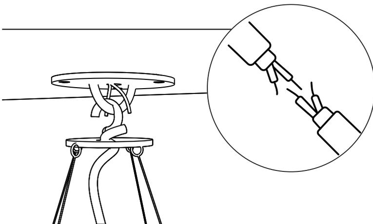
9. Realizar la conexión eléctrica entre los cables de la instalación y los del candil. Se recomienda asegurar la conexión con cinta de aislar.
