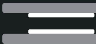
El límite de desgaste de las pastillas es un espesor mínimo de **0.5 mm**
