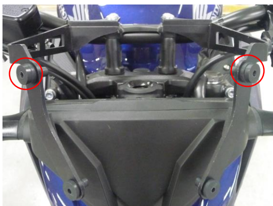
Position des pattes et des entretoises caoutchouc
