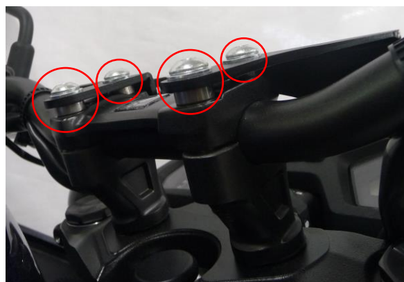
Position des entretoises métalliques
