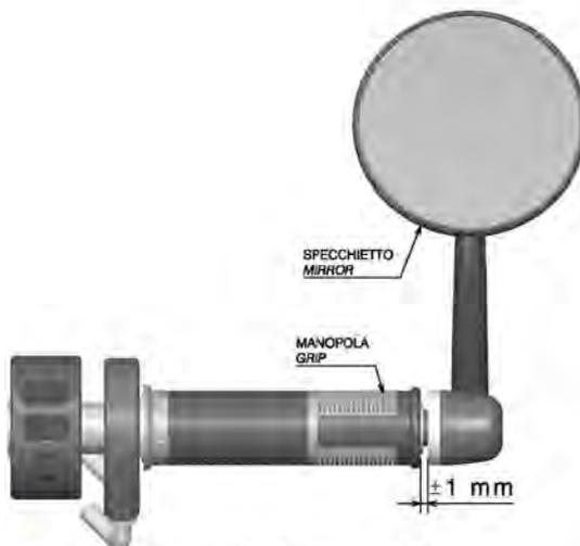
**⚠** **ATTENZIONE:** PER IL CORRETTO MONTAGGIO LATO DX CONTROLLARE CHE TRA IL DISTANZIALE DELLO SPECCHIETTO E IL COMANDO DELL'ACCELERATORE CI SIA CIRCA 1mm
