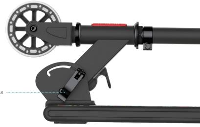
OPEN THE LOCKING LEVER ......(LOCATED ON THE RIGHT SIDE OF THE STIXIT)
