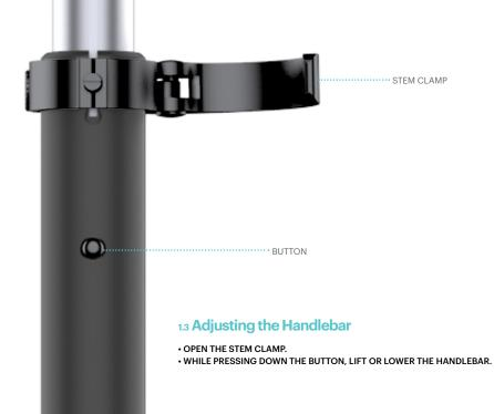
• WHEN YOU HEAR IT CLICK, TIGHTEN & CLOSE STEM CLAMP TO LOCK. MAKE SURE THE HANDLEBAR IS SECURE.
