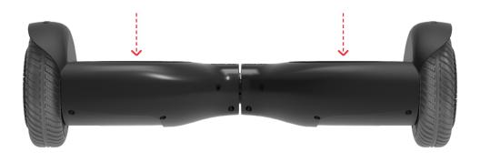
• TO TURN LEFT, ROTATE YOUR HIPS SLIGHTLY TO THE LEFT, WHICH WILL ADJUST THE DISTRIBUTION OF PRESSURE ON THE FOOTPADS AND MOVE THE RIGHT WHEEL AROUND FASTER THAN THE LEFT, AFFECTING A LEFT TURN.
