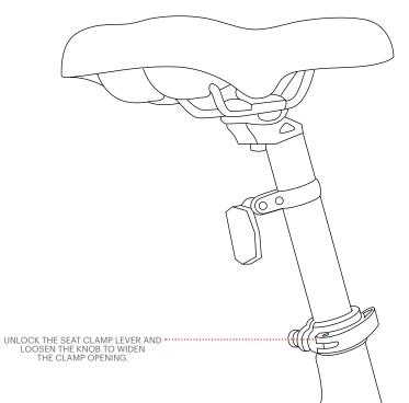
RAISE OR LOWER SEAT TO DESIRED HEIGHT WITHIN THE MARKED MINIMUM AND MAXIMUM INSERTION LINES.
