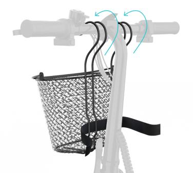
4. WRAP THE ENDS OF THE VELCRO STRAP AROUND THE STEM OF YOUR BIKE. SECURE THE ENDS TOGETHER BY FASTENING THE VELCRO. CHECK THAT THE STRAP IS SECURE.
