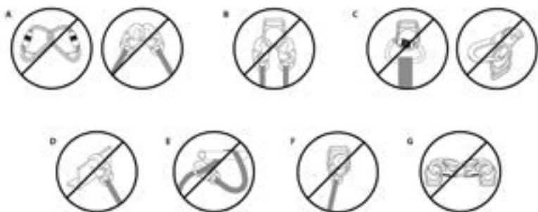
Figura 4 - Conexiones no compatibles
