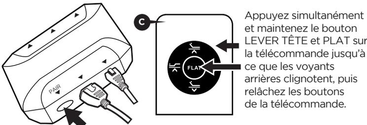
Double-cliquez sur le bouton APPAIRAGE sur le boîtier de commande (le voyant du boîtier de commande s'allumera en bleu) pour lancer le mode de d'appairage.
