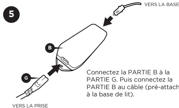
Connectez la PARTIE B à la PARTIE G. Puis connectez la PARTIE B au câble (pré-attaché à la base de lit).
