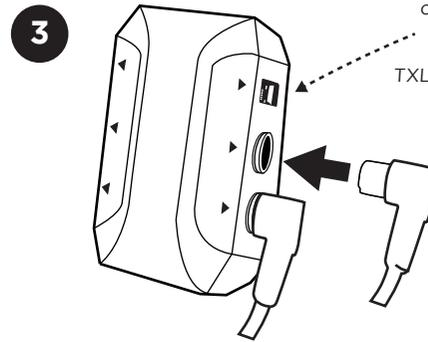
Insérez le câble du moteur section de pieds (bandeau rouge) dans le branchement intitulé « Moteur section pieds » sur le boîtier de commande.
