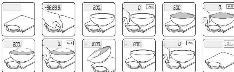
**NOTE:** En dessous de la fonction Tare, le poids total ne peut excéder la capacité de la balance.
