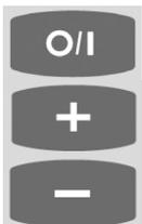
**Bouton Marche/Arrêt** - Pour allumer ou éteindre le moteur de l'agitateur. A sa mise en marche, l'agitateur tourne à une vitesse de 50 tours/min.
