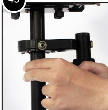
45. La main directrice vient, quant à elle, se placer juste en dessous du cardan. Avec 2 ou 3 doigts, tenez délicatement le tube principal comme le montre la photo 45. Utilisez votre main directrice pour orienter l'objectif de l'appareil dans la direction que vous voulez. Vous pouvez aussi déplacer la plateforme de contrepoids avec votre main d'orientation pour changer la direction de l'appareil comme le montre la photo 52.
