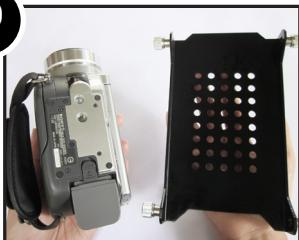
31. Vissez votre appareil sur la platine à travers le trou le plus proche. Assurez-vous que la platine soit bien en contact avec l'appareil.
