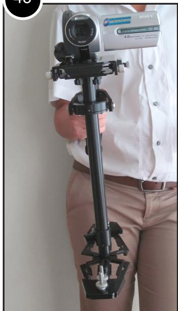
43. Le test du temps de chute permet de déterminer si le GLIDE GEAR DNA-5050 est à l'équilibre verticalement. Le test du temps de chute consiste à tenir la poignée du DNA-5050 dans une main. L'autre main amenant la plateforme de contrepoids à l'horizontale pour ensuite la lâcher de cette position. Le résultat du test, appelé «temps de chute», est déterminé par le nombre de secondes jusqu'à ce que la plateforme de contrepoids passe par la verticale (comme dans la photo 42) pour la première fois.
