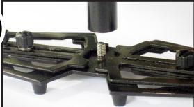
12. Vissez le tube télescopique sur la vis au centre de la plate-forme de contrepoids.
