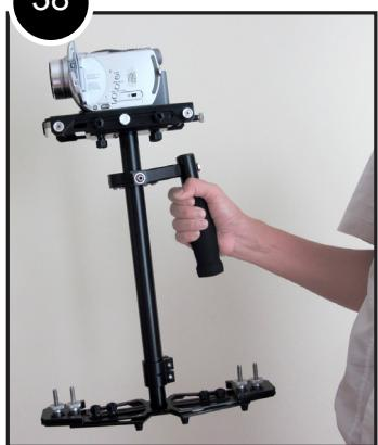
38. Comment savoir si le système est équilibré à l'horizontale. Pour tester l'équilibre horizontal, posez le GLIDE GEAR DNA-5050 sur une surface plate. Soulevez ensuite le DNA-1000 par sa poignée et laissez le pendre jusqu'à ce qu'il arrête de bouger. Le DNA-5050 est équilibré horizontalement si le tube principal est exactement à la verticale comme dans les photos 37 et 39.
