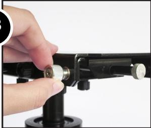
28. Il est temps maintenant de monter votre appareil sur la plate-forme de fixation du GLIDE GEAR DNA-5050. Pour cela, il vous faudra d'abord enlever la platine de fixation en dévissant les 4 vis sur les côtés de la platine.
