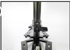
20. Insérez maintenant le tube télescopique dans le tube principal où est attaché le cardan du DNA-5050.
