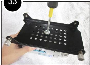
33. Placez ensuite votre appareil entre vos jambes ou sur une surface rembourrée telle qu'une serviette pliée sur une table par exemple. Utilisez un tournevis pour bien visser la vis et la rondelle d'1/4 de pouce sur la platine au-dessous de votre appareil.
