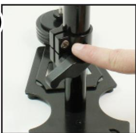
21. Tournez le tube principal afin que la poignée du serre-joint soit alignée avec la plateforme de contrepoids conformément à la photo 21. Ajustez la distance entre la plateforme de contrepoids et le tube principal pour qu'il y ait 1 pouce (2-3 cm) entre les deux. Alignez la poignée du serre-joint n'affecte en rien le fonctionnement du stabilisateur mais permet de l'équilibrer plus rapidement.
