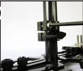
26. Il existe deux manières d'aligner les deux plateformes. La première, qui est aussi la plus simple, consiste à desserrer la poignée du serre-joint et à tourner les tubes de façon à ce qu'ils soient alignés comme sur la photo 27. Une fois dans la bonne position, resserrez la poignée tout en maintenant une distance de 1 pouce (2-3cm) entre la plateforme de contrepoids et le serre-joint.
