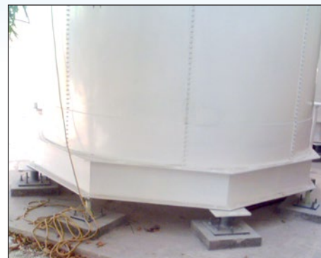
Celdas de carga para uso industrial, tipo CU (Canister) o ITA (Bajo perfil)
