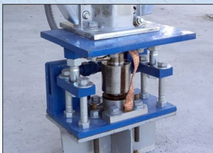
Celda de carga tipo CU (Canister) con montaje check
