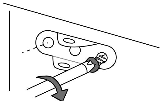
6. Führen Sie die Unterlegscheibe durch beide Löcher der Halterung und ziehen Sie sie fest.
