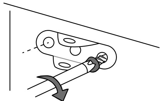
6. Passez la rondelle à travers les deux trous du support et serrez-la.
