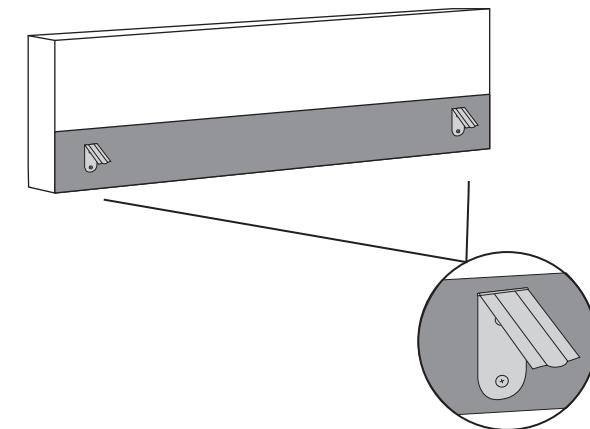
**2.** Placez délicatement le dossier en insérant les languettes dans les ancrages de la structure pour fixer les deux pièces.
