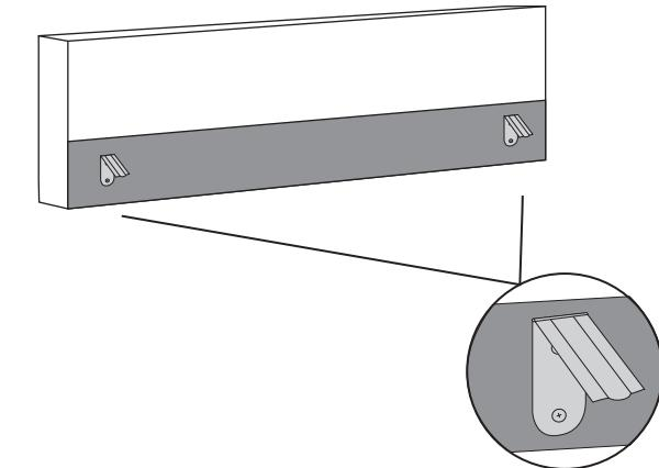
**2.** Setzen Sie die Rückenlehne vorsichtig ein, indem Sie die Laschen in die Verankerungen der Struktur einführen, um beide Teile zu fixieren.
