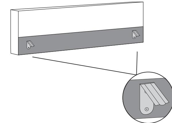
**2.** Coloca el respaldo con cuidado introduciendo las lengüetas en los anclajes de la estructura para fijar ambas piezas.
