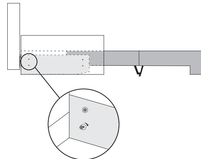
6. Abre de nuevo el sofá para fijar los dos tornillos en la parte delantera del reposabrazos.
