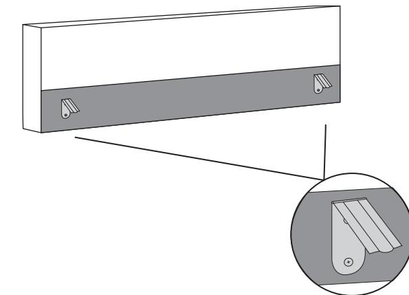
2. Posiziona il poggiapiede con attenzione inserendo le linguette negli ancoraggi della struttura per fissare entrambe le parti.
