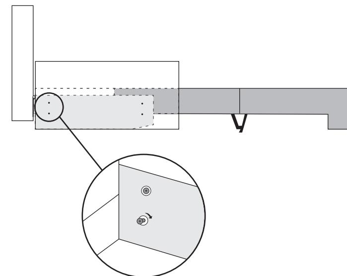
6. Abra novamente o sofá para fixar os dois parafusos na parte da frente do braço.
