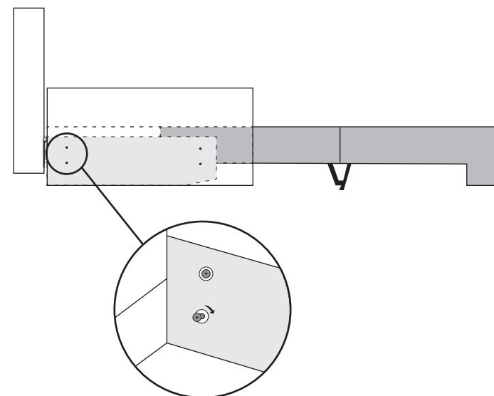
6. Öffnen Sie das Sofa erneut, um die beiden Schrauben an der Vorderseite der Armlehne zu befestigen.
