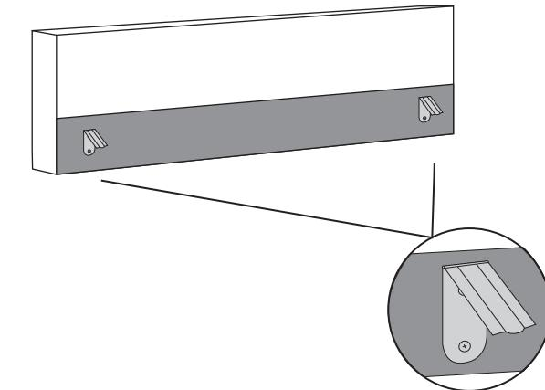
**2.** Coloque o encosto com cuidado, inserindo as linguetas nos encaixes da estrutura para fixar ambas as peças.
