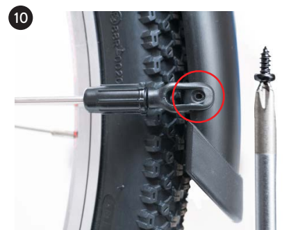
10 4x g + links & rechts / left & right + festziehen mit / tighten with E
