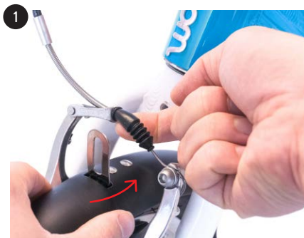
1 anheben & durchführen lift up & position
