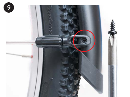
9 2x g + links & rechts / left & right + festziehen mit / tighten with E
