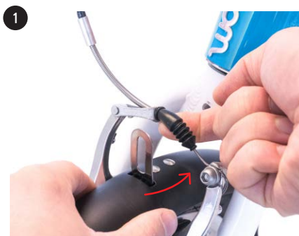
1 anheben & durchführen / lift up & position
