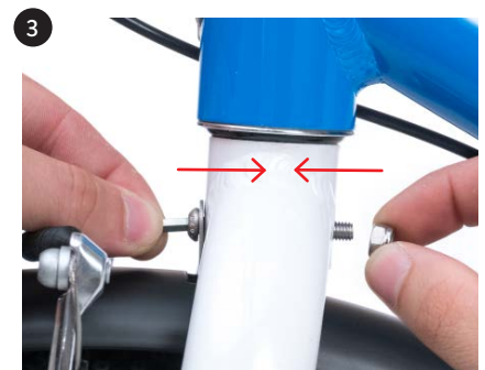
3 h + k + festziehen mit / tighten with B
