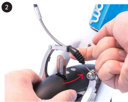
2 anheben & durchführen / lift up & position
