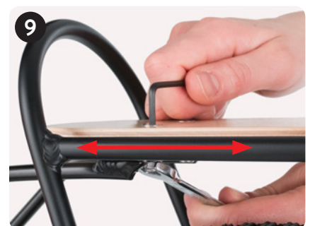
9 Für Feinadjustierung Schraube lösen mit A + C Minor bolt adjustment with A + C
