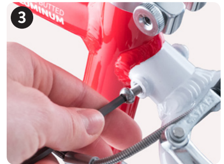
3 Beidseitig Schrauben lösen mit B Remove screws with B on both sides
