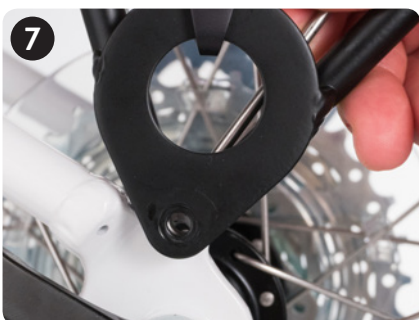
7 Bohrungen und Schutzblechhalterung ausrichten Align both fender and rack holes to the frame hole
