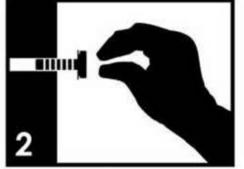
Positionnez correctment chacune des pièces et insérez les vis dans leurs orifices respectifs. Puis serrer à la main seulement jusqu'a 70 %. Resserrement complète avec les outils viendre à une étape ultérieure.
