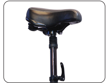
Fig. 4.3 Support de siège inséré adéquatement, 1/4 » au-delà de la « Ligne d'insertion minimale »
