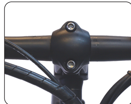
Fig. 1.4. Façade du Guidon avec des boulons serrés
