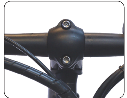
Fig. 1.4. Façade du Guidon avec des boulons serrés
