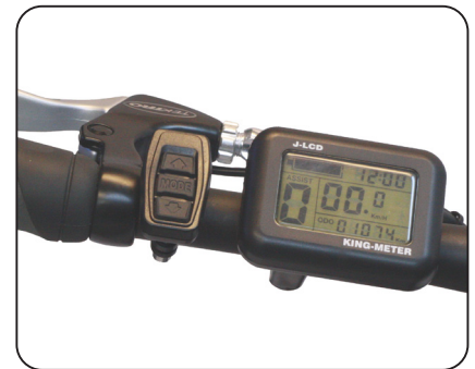
Fig. 9.3 Afficheur du King Meter®, Réglez « ASSIST » sur « 0 », lors de la programmation
