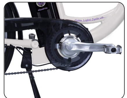
Fig. 3.2 Bras de manivelle, pédale droite insérée
