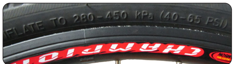
Fig. 5.1 Pression de gonflage des pneus
