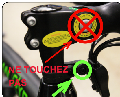
Fig. 1.6 Serrez la vis du câble (vert)
