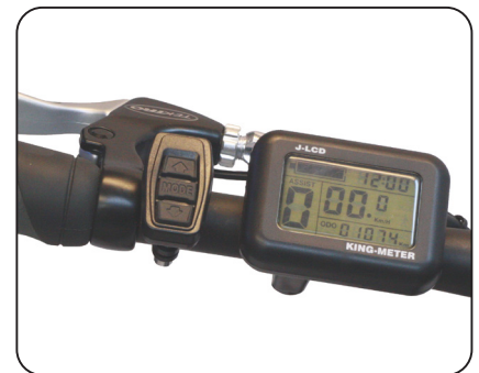
Fig. 11.3 Afficheur King Meter®, réglez ASSIST sur « 0 » pendant la programmation
