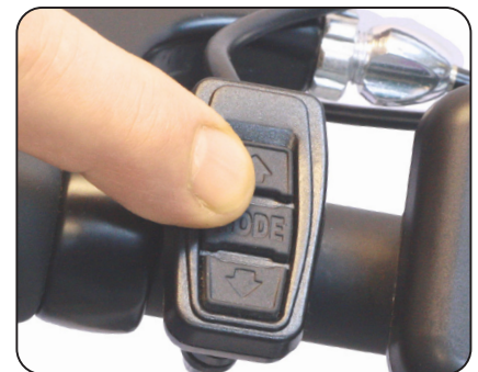
Fig. 11.2 Luminosité de l'écran et phare de vélo, maintenez le bouton MODE et la flèche HAUT pendant 3 secondes
