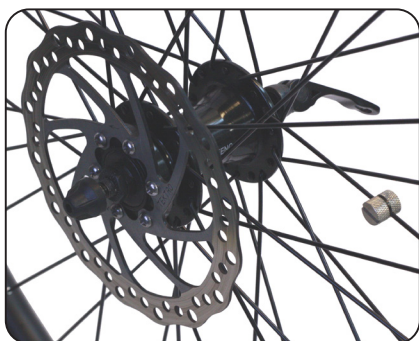
Fig. 2.3 Roue avant à dégagement rapide insérée dans l'axe de roue
