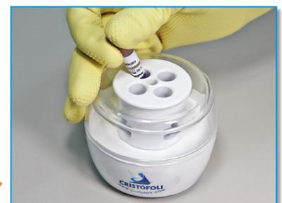
**7** Introduzca 1/3 de la ampolla test dentro de la incubadora para activarla, doble la parte superior de la ampolla plástica flexible. Eso resultará en la quiebra de la ampolla interna de vidrio, liberando el medio de cultivo para contacto con las esporas. Cuidado para no romper la parte plástica.
