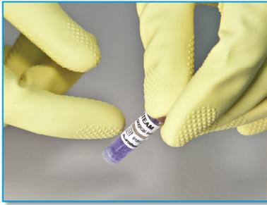
**8** Sujete la ampolla de acuerdo con lo demostrado. Dé un capirotazo en la parte inferior de manera que se traslade solamente esta región del tubo. Certifíquese que el medio de cultivo morado impregnó totalmente el disco con esporas. La parte superior de la ampolla posee un filtro hidrofóbico, (ver foto detallada de la ampolla en la página 2) que no debe ser mojado, por ese motivo, no agite la ampolla.
