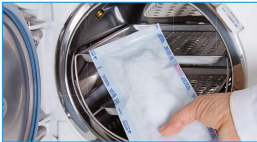
**16** Para descartar las ampollas control (o test con crecimiento bacteriano positivo) esterilice antes. Envuelva en algodón y cinta adhesiva, coloque dentro del papel grado quirúrgico. Caso el resultado de la ampolla test haya sido positivo (crecimiento bacteriano), el motivo debe ser investigado y solucionado antes de esterilizar las ampollas. Consulte el paso 12-II para interpretar los resultados.
