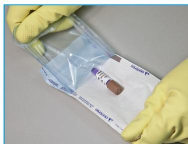
**6** Terminado el ciclo de esterilización, espere 15 minutos para que se enfríe. Abra el sobre y recupere la ampolla test autoclavada.
