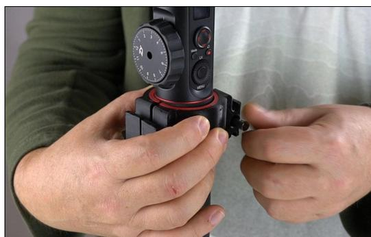
1. Prendi le metà del supporto, i bulloni forniti con il supporto e la chiave a brugola M4 (la chiave a brugola di medie dimensioni).
