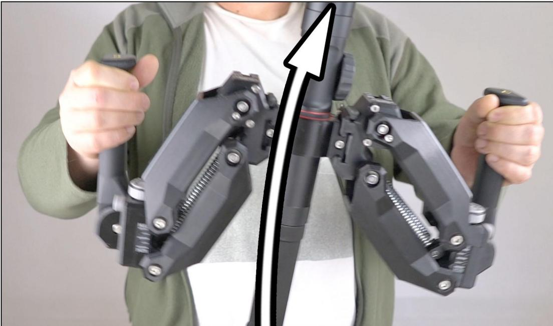
Se il tuo gimbal rimbalza a destra, allora la molla del carico utile destra è più debole della sinistra e devi aumentare la tensione del regolatore del carico utile sul lato destro per livellarla con la sinistra. Quando il tuo gimbal rimbalza verso l'alto, sei pronto per iniziare il tuo tiro di prova!
