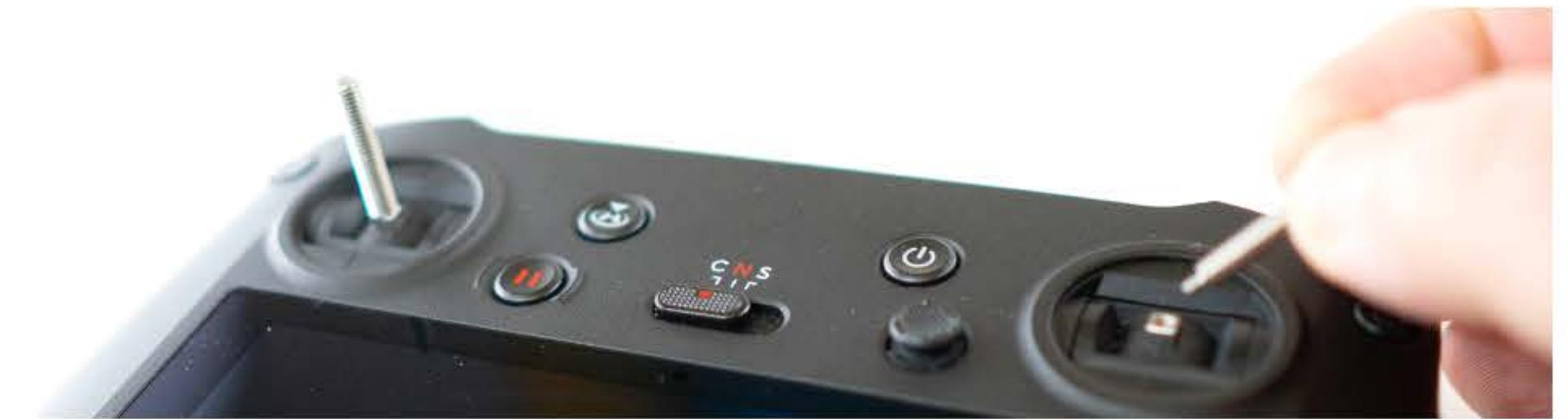
ネジ付き金属棒をコントローラーにねじ込みます。
