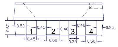
焊盤、焊錫腳示意圖
