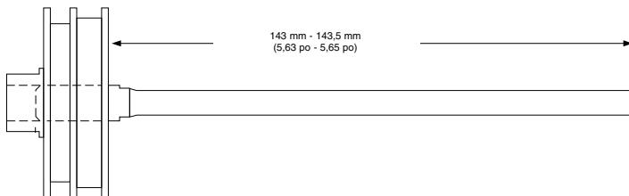
**REMARQUE :** Dans la plupart des utilisations, une usure de 3 mm (1/8 po) de l'enfonceur peut être tolérée. Néanmoins, dans le cas d'une utilisation plus complexe, une usure d'environ 1,5 mm (1/16 po) peut provoquer une légère réduction de la puissance apparente d'enfoncement.
