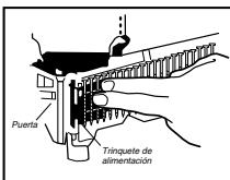
**1) Abra el cargador:** Hale el pestillo de la puerta hacia abajo y gire y abra la puerta. Gire y abra la tapa del cargador.
