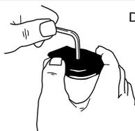
Desserrer la vis comme indiqué. Régler en fonction de la direction d'échappement souhaitée, puis resserrer la vis.
