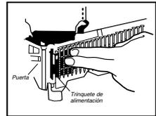
1) **Abra el cargador:** hale el pestillo de la puerta hacia abajo y gire y abra la tapa del cargador.
