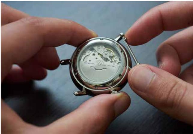
**01** An den mitgelieferten Federstegen findest Du einen kleinen Metallstift. Schiebe diesen nach innen und lasse die Federstege in die Einkerbungen am Gehäuse einrasten.
