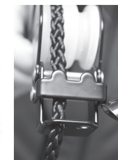
Mise en place de la corde dans le frein
