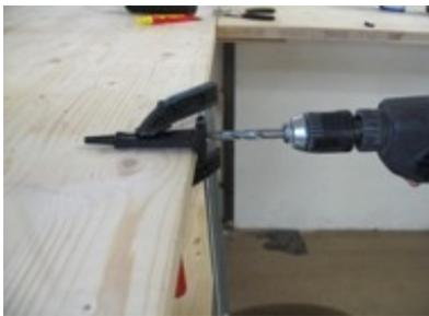
2. Placer le morceau de la pompe à une table et percer le morceau cassé de la poignée (env. 1.5cm). Il est nécessaire par conséquent, un trépan de forage de 10mm.
