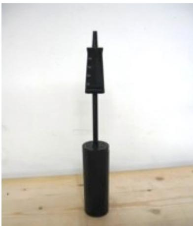
4. Insérez le tube en plastique dans le manche percé (voir photo). Veiller à ce que la colle ne va pas ostruer le passage de l'air.
