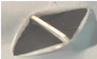
2. Avec de la colle PVC peindre la coupe dans le patch de réparation et d'attendre 10 minutes jusqu'à ce que la colle soit sèche. Un ou plusieurs racleurs pour supporter l'utilisation, de sorte que les corps sont exposées à l'air.
