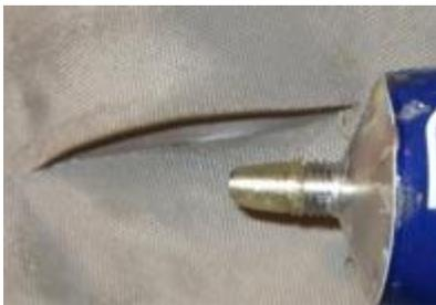
2. Avec de la colle PVC le patch de réparation et à la moyenne sur une grande surface à peindre et attendre 10 minutes jusqu'à ce que la colle a déménagé dans le tissu. Pour le côté droit note: [rugueuse à côté rugueux].
