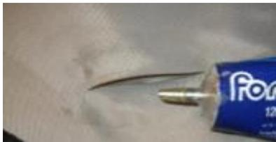
3. Mettre la colle adhésif avec la face vers le haut sur la pièce de réparation et insérer dans la section de l'Airboard.
