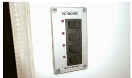
Wird eine Druckwasserpumpe verbaut, sollte beim Eingang ein Schalter montiert werden, mit dem man die Wasserpumpe beim Verlassen des Fahrzeugs abschalten kann. Ich habe einen Mehrfachschalter montiert, mit dem ich auch die Außenbeleuchtung sowie die wc-Entlüftung an- und abschalten kann.
