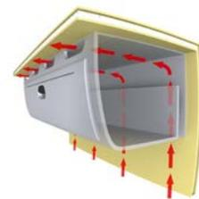
Die Hinterlüftung von Deckenkästen ist relativ einfach möglich.
