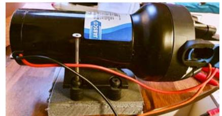
Die Druckwasserpumpe sitzt nicht wie eine Tauchpumpe im Tank, sondern außerhalb. Sie sollte möglichst auf Silentblöcken gelagert werden, um eine Schallübertragung auf das Fahrzeug/den Möbelbau zu unterbinden. Gegebenenfalls kann man auch noch ein Stück Dämmmatte unterlegen.
