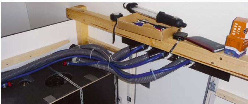
Um die Auflagefläche für die Lattenroste zu vergrößern, setze ich an der Kopfseite, wo die Wasserschläuche verlaufen, das Vierkantholz nicht oben auf die Bettpfosten, sondern schraube es frontal an. Dadurch sind auch die Wasserschläuche zur Befüllung der Wassertanks besser geschützt.
