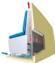
Mit Konvektoren kann die Luftzirkulation ideal erzeugt werden. Ein geschlossener Luftheizungsrohr tut es aber auch.
