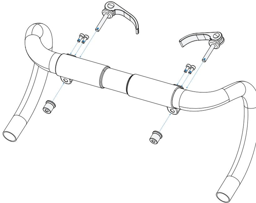
7. Installieren Sie die Stangen an einem Fahrrad, indem Sie den mittleren 31,8-mm-Abschnitt klemmen und die Vorbauschrauben bei 6 Nm festziehen.
