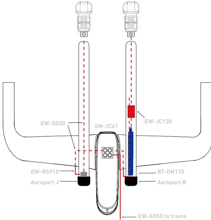
电池在框架中 · 无刹车/换档杆
