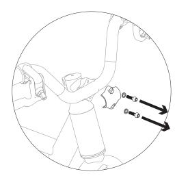
**5.** Volver a incorporar la pieza frontal con los pernos, ajustar por igual el perno superior e inferior.
