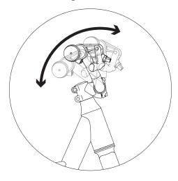
**3.** Ajustar nuevamente los dos pernos frontales de la Tee con la llave allen №5, asegurando que no se mueva y esté completamente fija.
