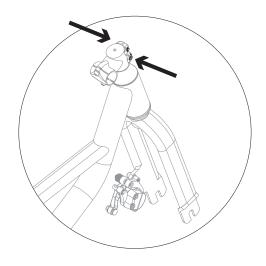
**2.** Girar y posicionar la Tee hasta que quede paralela (||) al eje de dirección.
