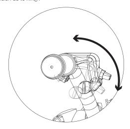
**3.** Ajustar nuevamente el perno del manillar con la llave allen N°5, asegurando que no se mueva y esté completamente fija.
