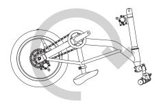
**8.** Posicionar la rueda frontal en la horquilla y ajustar las tuercas en ambos costados con la llave corona N<sup>o</sup>15.
