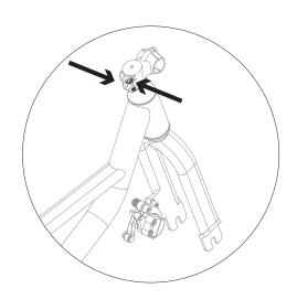
**4.** Soltar los dos pernos frontales de la Tee con la llave allen  $N^{\circ}5$ , retirar la pieza frontal con los pernos y posicionar el manubrio centrado (asegurar que la manilla izquierda del manubrio es la que acciona el freno frontal).
