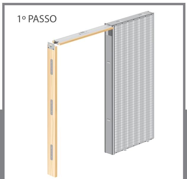
Colocar a guia de alumínio e o batente de madeira na armação.
