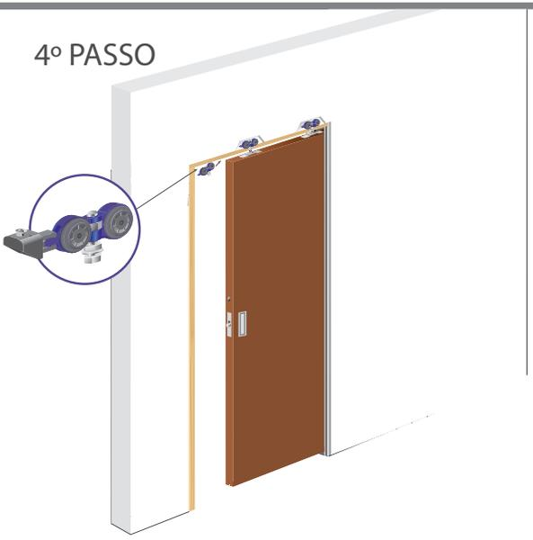
Uma vez aplicada a massa ou argamassa e seca, tiramos as marcações e os distanciadores. Dentro da armação encontramos uma caixa com os rolamentos e os fixadores da porta e travão. Segundo as instruções da presentes na caixa, fixamos os fixadores da porta, depois introduzimos os rolamentos em guia segundo o desenho e finalmente colocamos a porta e o travão.
