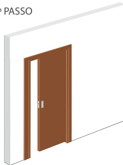
Por ultimo, proceder à colocação do kit de batente de madeira na pré-marcação, ficando a instalação completa.
