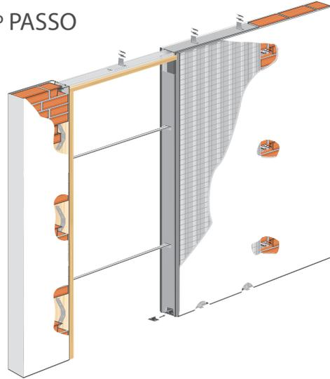
Colocar a armação na parede e colocar a divisória de azulejo aplicando a massas ou argamassa (**nunca aplicar o gesso directamente na estrutura**).
