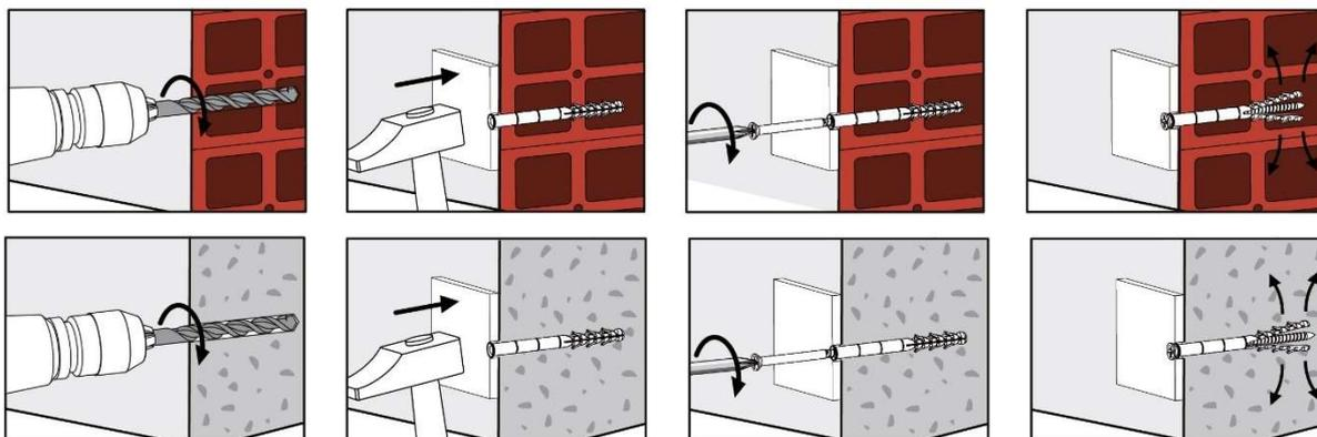
Para la colocación del modelo SS se usa vaso hexagonal.
