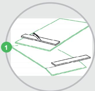
Cortar nos dois lados com uma ponta afiada ou faca. Quebrar ao longo do corte
