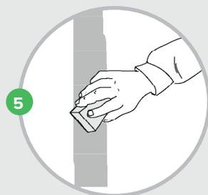
5 Lixe a superfície para alisar a massa. Se necessário, adicionar material de enchimento adicional
