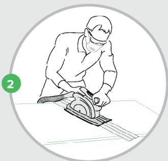
Usar a serra circular ao longo de uma linha guia auxiliar
