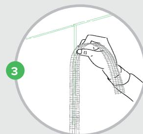
3 Aplique fita de acabamento resistente a álcalis sobre as juntas
