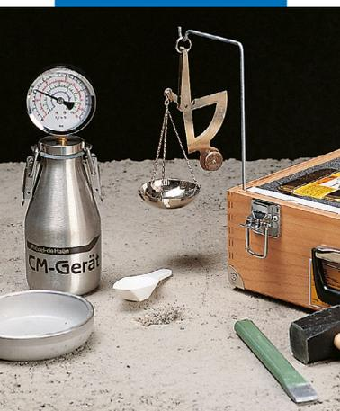
Medição da humidade de betonilhas Mapecem mediante higrómetro de carboneto
