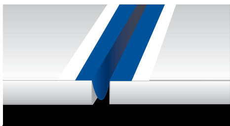
Posicionamento em ómega de Mapeband no interior da junta de dilatação
