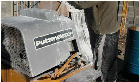
**1.** Amassar o produto, de preferência mecanicamente. Em máquinas com doseamento automático de água regular o caudal por forma a obter uma argamassa com consistência plástica. Em máquinas sem doseador de caudal de água misturar um saco de Rebetop Plus+ Hydro com 3,5 a 4 L de água limpa, até obter uma massa de consistência plástica e homogénea.
