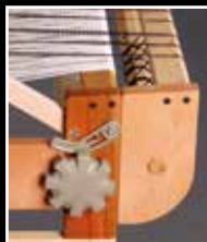
セカンドバックビーム 織り機の後ろにローラーとビームを追加するキットです。伸びの違う2種類のため糸の張りを整えます。織り機の幅に合わせて40cm、60cm、80cm幅用があります。
