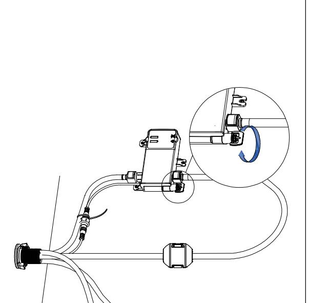
**14.** Pour le fonctionnement manuel, tourner le bouton en-dessous du boîtier de contrôle anti-horaire jusqu'au bout (comme l'illustration 14). Le capteur va se désactiver et le robinet marche seulement avec la poignée.
