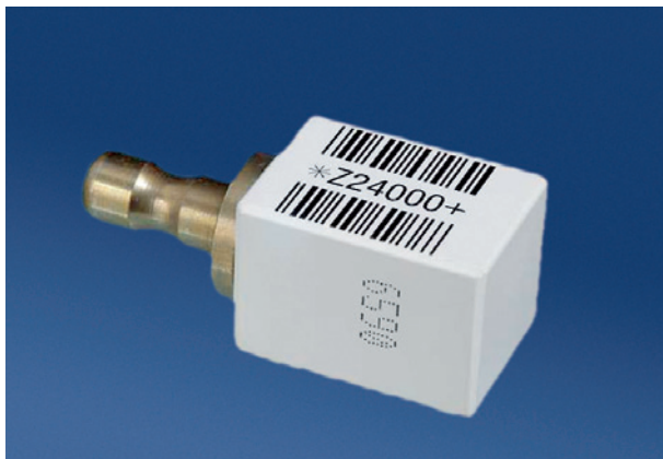
Slika 11.10. ZY-Cubes su označeni barkodom. Broj 24 nakon Z označava kontrakciju u postocima. Laserski skener inLab uređaja prije glodanja očitava ovaj kod.
