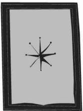
L'anneau de tuyau de poêle peut accommoder un tuyau jusqu'à 5 po de diamètre. **Ne prolongez pas les fentes.**
