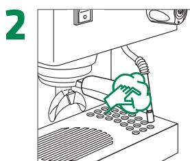
Pulire la lancia vapore/erogatore acqua calda
