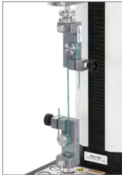
Wire tensile testing
